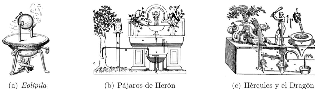
**Figura 1.1:** Algunas de las invenciones descritas por Herón de Alejandría. (a) *Eolípila* de Herón de Alejandría, antepasado de la máquina de vapor. (b) Pájaros de Herón. (c) Autómata descrito por Herón que representa a Hércules luchando con un dragón. Cuando Hércules golpea la cabeza del dragón, este último arroja agua contra la cara del héroe.
